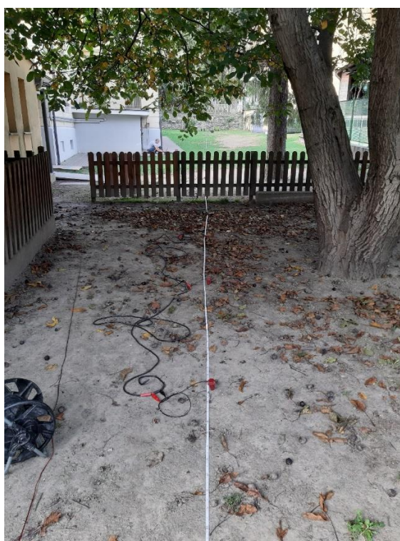
Fig. 10 – Esecuzione della Prova sismica MASW a valle
