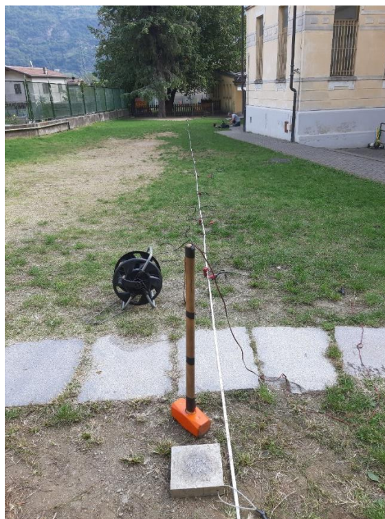
Fig. 9 – Esecuzione della Prova sismica MASW a monte
