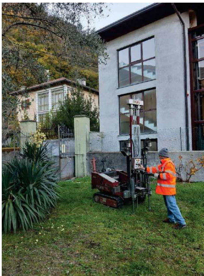
Fig. 10 – Esecuzione della prova penetrometrica dinamica SCPT3 (P3)
