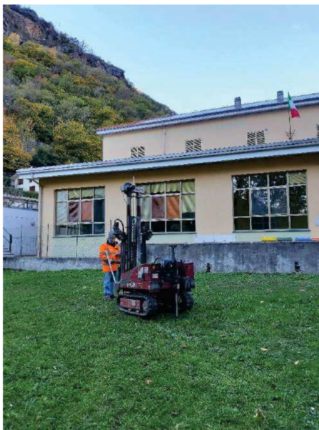
Fig. 6 – Esecuzione della prova penetrometrica dinamica SCPT1 (P1)
