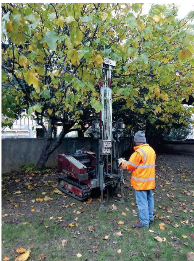
Fig. 8 – Esecuzione della prova penetrometrica dinamica SCPT2 (P2)
