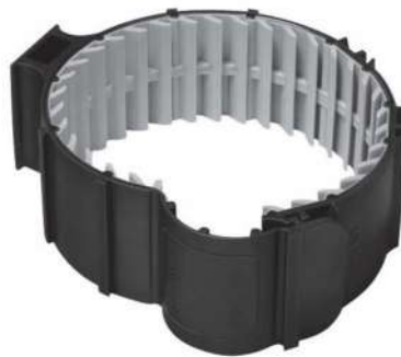
Collare Bampi, adattabile a tre diverse tipologie di tubazioni (si monta sul 70, sul 90 e sul 110). Ha due gradi di svincolamento, uno all'interno (alette interne a forma di dente di pesce cane), e uno nell'attacco. Viene fissato su una barra filettare.
