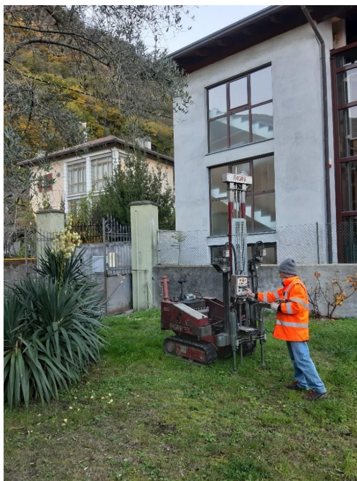
Fig. 10 – Esecuzione della prova penetrometrica dinamica SCPT3 (P3)
