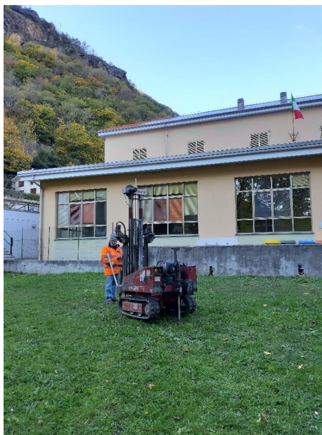
Fig. 6 – Esecuzione della prova penetrometrica dinamica SCPT1 (P1)
