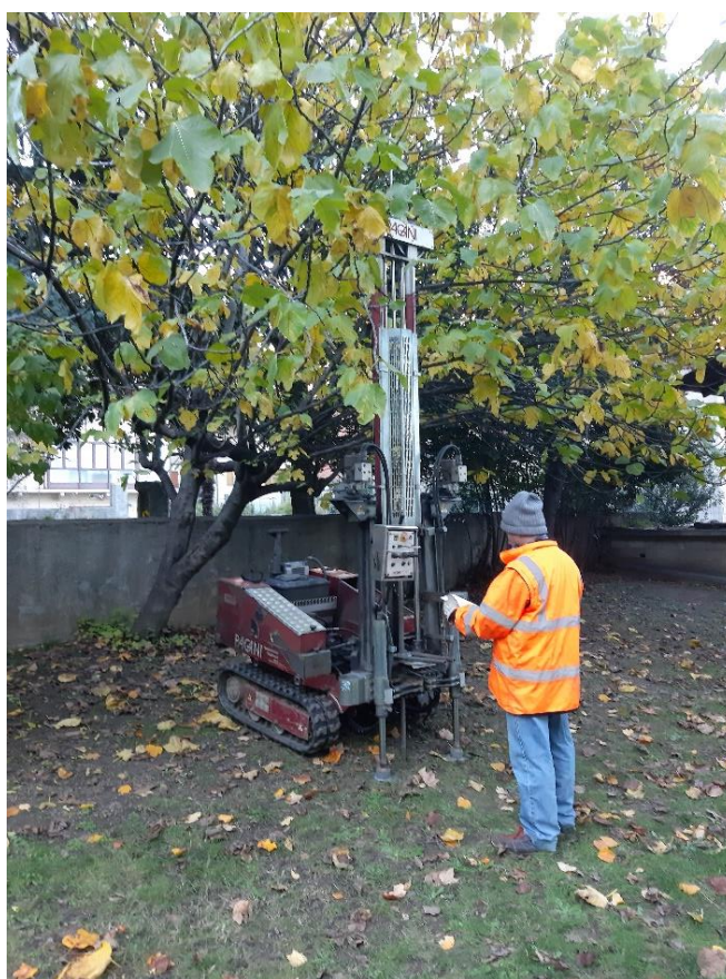
Fig. 8 – Esecuzione della prova penetrometrica dinamica SCPT2 (P2)
