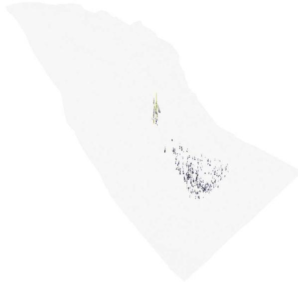
Numero di punti di arresto delle traiettorie sul versante - istogramma.
