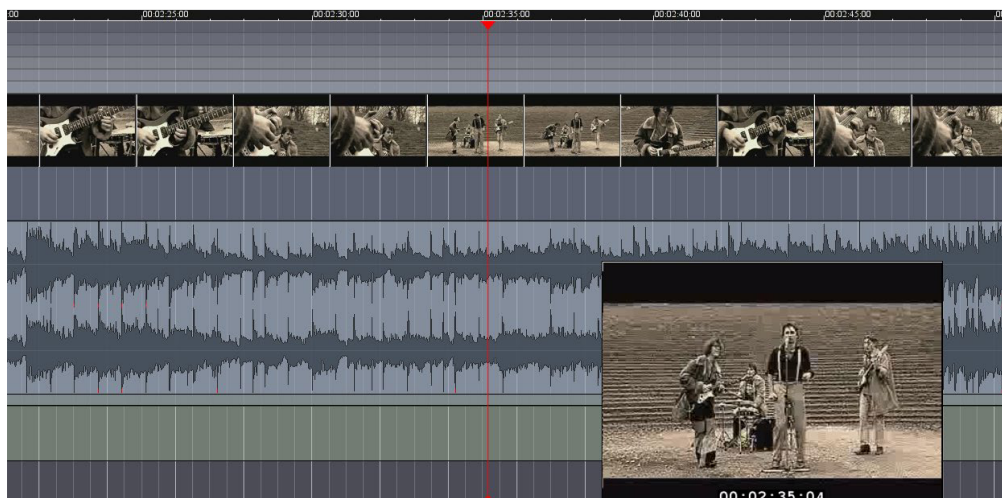
Figura 1 Esempio di una timeline semplice di un file multimediale con una traccia video (monoscopica) e una traccia audio binaurale (2 canali stereo).
