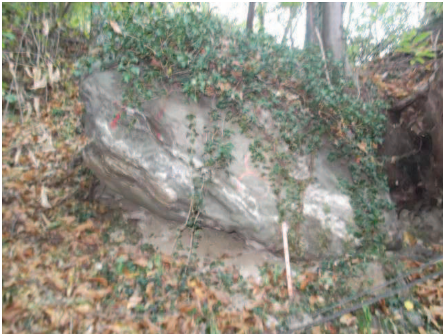
Foto 23-23bis – Blocco 18 di 6.75mc monitorato con fessurimetro. Si apprezza uno spostamento centimetrico
