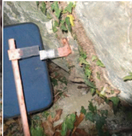
Foto 23-23bis – Blocco 18 di 6.75mc monitorato con fessurimetro. Si apprezza uno spostamento centimetrico
