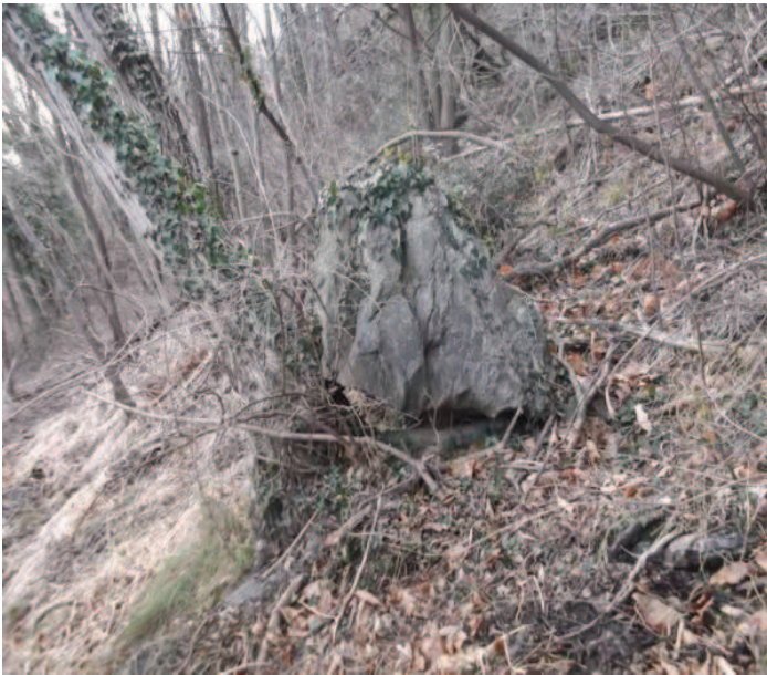
Foto 44 – Blocco 33 (0,7 mc) appoggiato ad un albero posto poco a nord della casa rurale a q 400 m ca.
