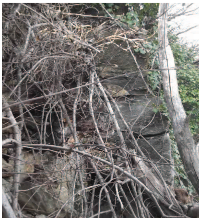
Foto 40-41 – Situazione 31. Comparto roccioso fratturato alla sommità della balza rocciosa q. 365 m ca. suddiviso in blocchi da 0,5-1 mc max
